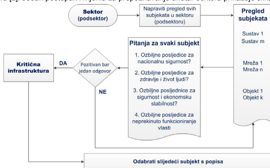
Slika 2. Postupak prepoznavanja kritične infrastrukture unutar sektora ili podsektora.
