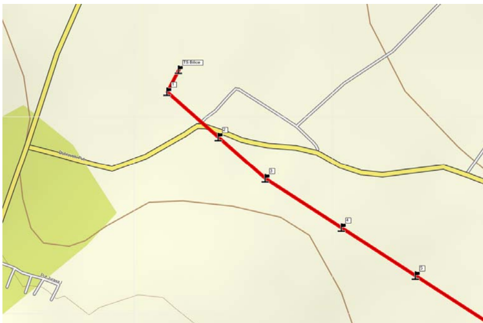
Slika 9. Prikaz trase i stupnih mjesta dalekovoda na Garmin GPS uređaju
