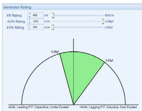
Slika 3. Dopušteni tolerantni raspon proizvodnje jalove energije generatora
