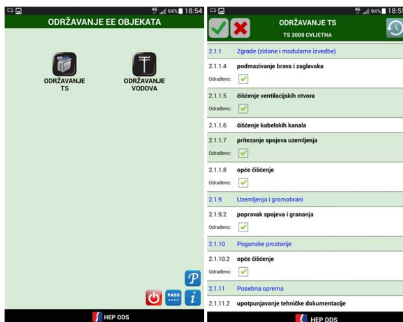
Slika 6. Redovno održavanje TS 10(20)/0,4 kV pomoću mobilnog APOEEO-a
