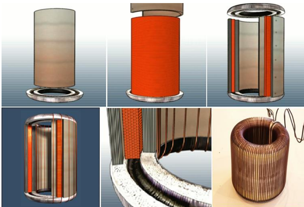
Slika 3. Koraci izgradnje prigušnice s promjenjivim induktivitetom [3]
