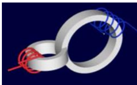
Slika 2. Dva namota sa efektom prividnog zračnog raspora
