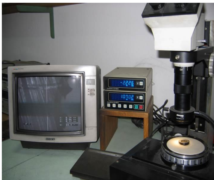
Slika 1. Ispitivanje debljine zaslona izolacije
