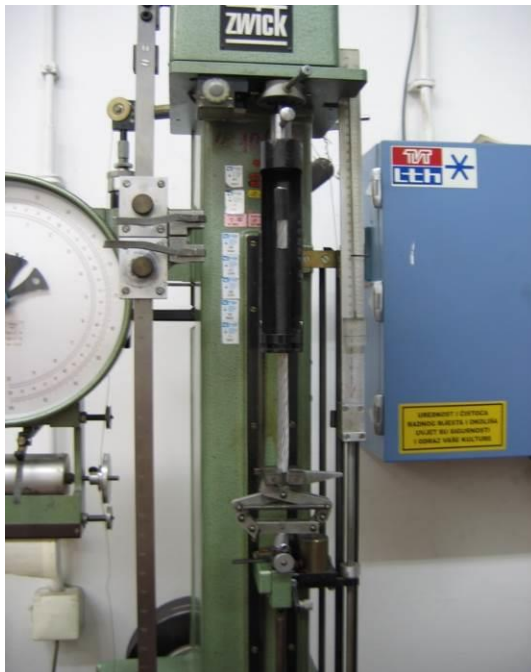
Slika 3. Ispitivanje izolacije neutralnog vodiča prema postupku 2.2.2
