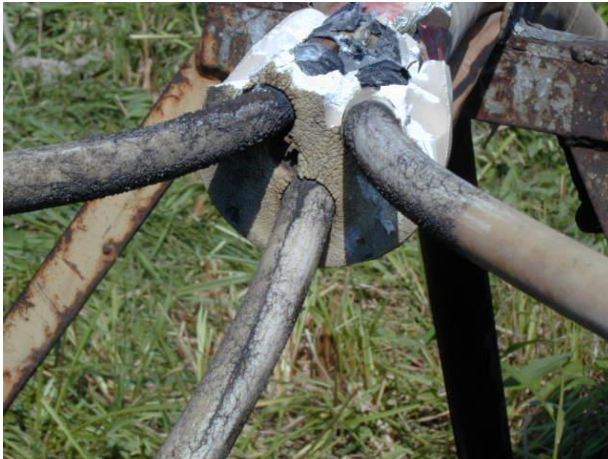
Slika 5. Kabelska glava u kvaru
