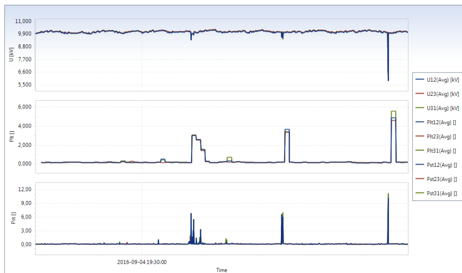
Slika 5. Prikaz srednjih vrijednosti napona i flikera za period prije puštanja FNE u paralelni rad s DM
