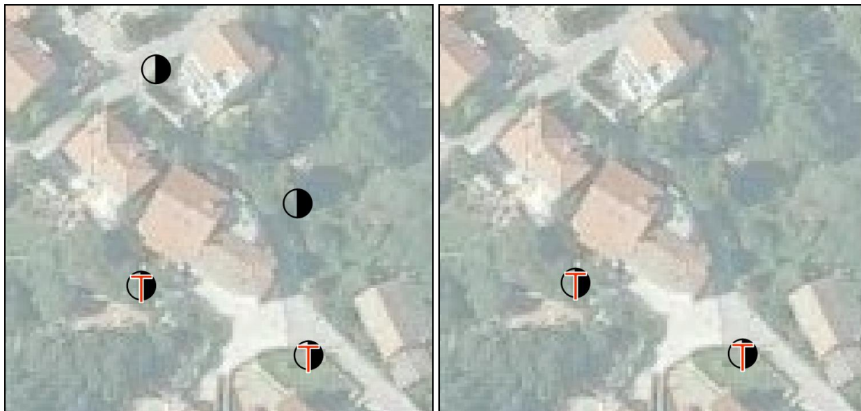
Slika 5. Primjer prikaza stupova s telekomunikacijskim vodovima u QGIS-u
