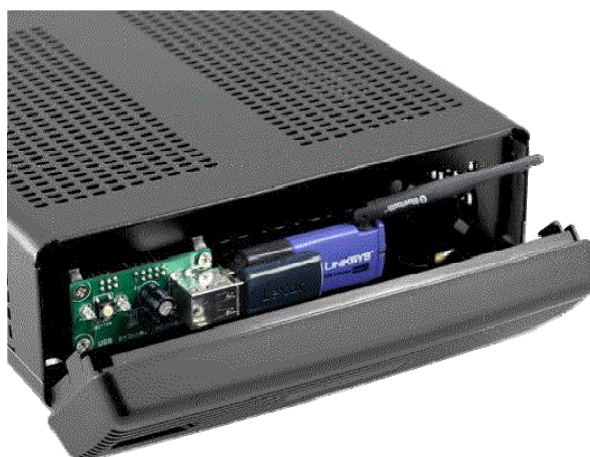
Slika 1. DCU s integralnim 3G modemom
