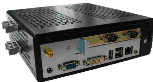
Slika 2. DCU pogled sa stražnje strane – komunikacijsko sučelje
